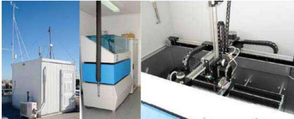
Εικόνα. Αυτόματο σύστημα (σταθμός) μέτρησης των επιπέδων ραδιενέργειας αιωρούμενων σωματιδίων στην ατμόσφαιρα (Aerosol monitor) και μετεωρολογικών παραμέτρων.
