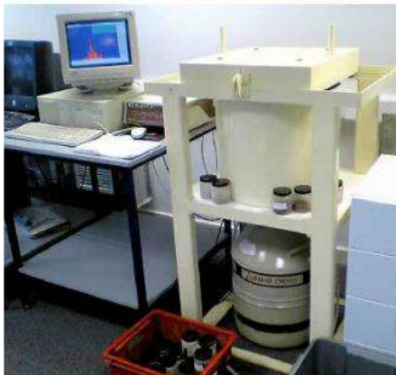
Εικόνα. Σύστημα γ-φασματοσκοπικής ανάλυσης υψηλής ευκρίνειας με ανιχνευτή υπέρ-καθαρού γερμανίου (HPGe) και θωράκιση.
