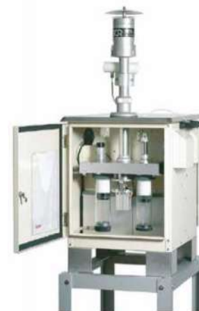
Εικόνα. Δειγματοληπτική αντλία μικρής ροής αέρα με αυτόματη εναλλαγή πολλαπλών φίλτρων για τη συλλογή αιωρούμενων σωματιδίων στην ατμόσφαιρα.
